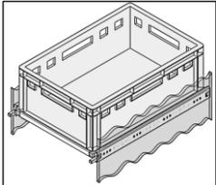
➔ **Plattenbauweise** aus Multiplex, Tischlerplatte oder Ähnlichem, empfohlene Mindestmaterialstärke: 12 mm
