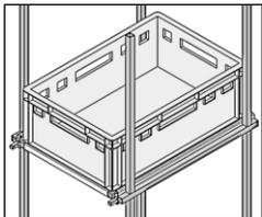
➔ **Metallprofile bzw. Mischbauweise** Rohrrahmen aus Metall Vierkantprofilen oder dünnes Holz (Bsp: ITEM, Stahlrahmen oder 6 mm Sperrholz)
