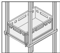
➔ **Rahmenbauweise** aus vierkant Konstruktionsholz, empfohlene Mindestmaterialstärke: 35 mm
